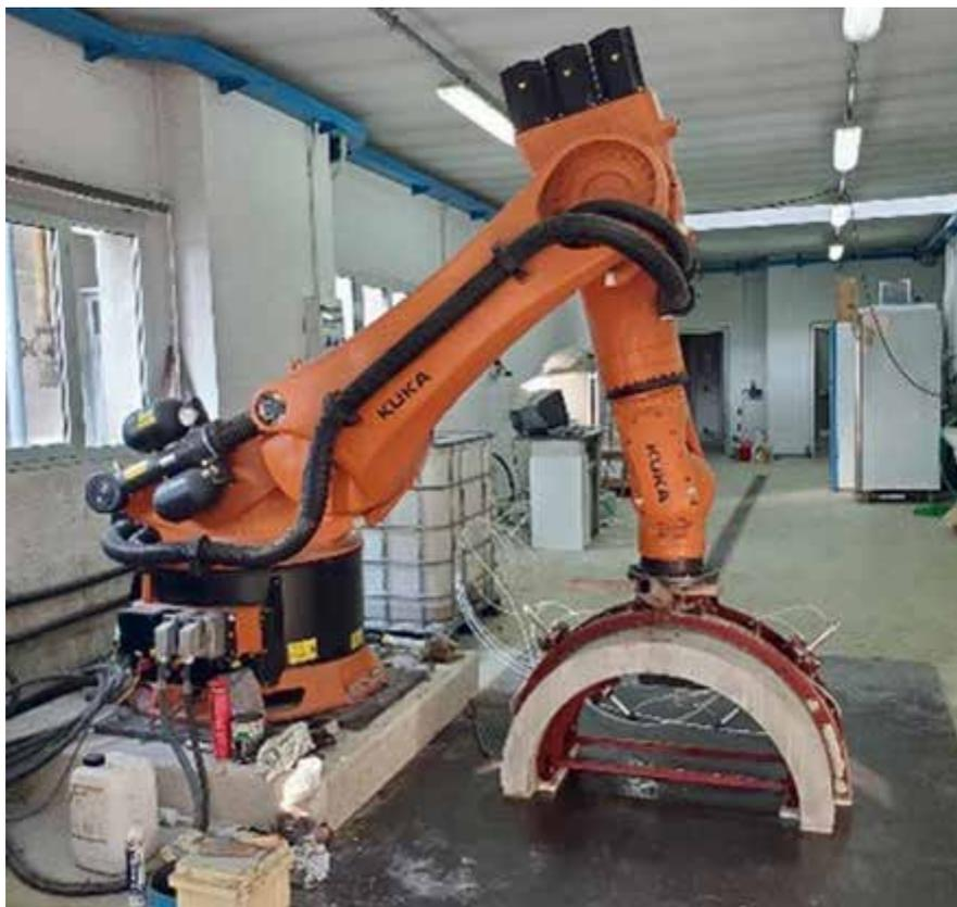
1. IL PRIMO PROTOTIPO REALIZZATO NEL LABORATORIO SPERIMENTALE PRESSO LO STABILIMENTO BUZZI UNICEM DI TRINO (VC) DER ERSTE IM VERSUCHSLABOR DES WERKS VON BUZZI UNICEM IN TRINO (VC) HERGESTELLTE PROTOTYP
